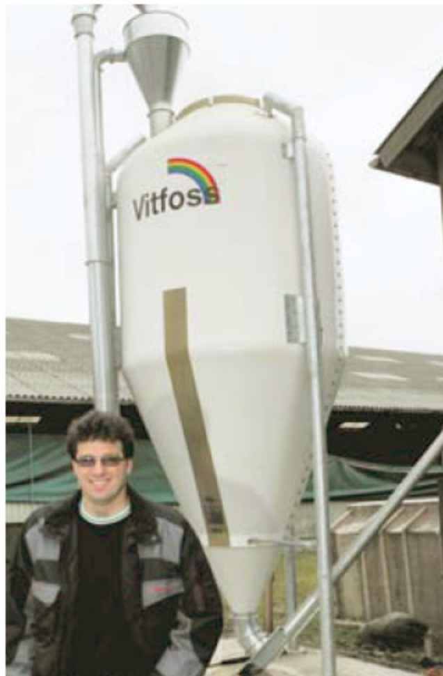
Siloen fra MHJ/Vitfoss til 6 ton mineraler passer fint til behovet på Tax-Meer I/S, hvor de dagligt bruger ca. 130 kg YeaMix. Jos Tax er således godt tilfreds med den nye investering, der har snegl direkte ind i foderladen. Foto: Jørgen Kølle
